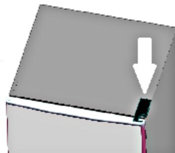
2. Entfernen Sie die Halteschrauben des oberen Scharniers (Kreuzschraubenzieher).
