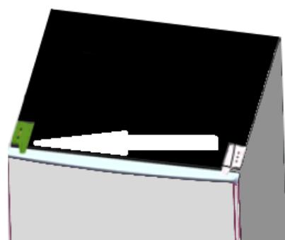
10. Setzen Sie die obere Tür ein und befestigen Sie das obere Scharnier und die obere Scharnierabdeckung.
