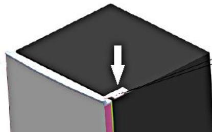
3. Entfernen Sie das obere Scharnier (A), das Begrenzungsstück (B) und die Türlagerbuchse.
