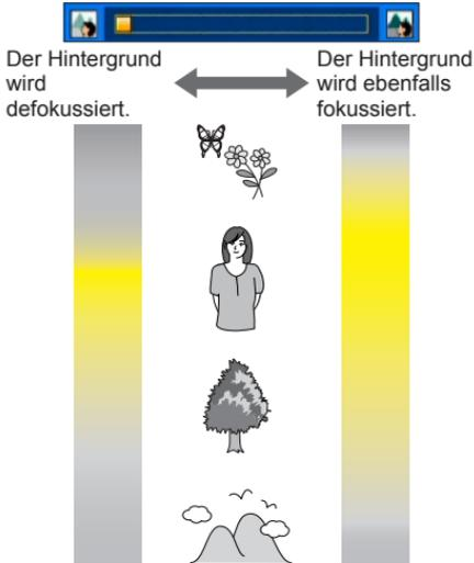
Der in der Abbildung links gelb dargestellte Bereich kennzeichnet den Bereich, innerhalb dessen das Bild scharf ist.
