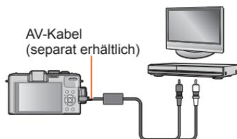
An Eingangsbuchse des Recorders
