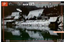
Der für jedes Bildseitenverhältnis aufnehmbare Bereich wird angezeigt.
