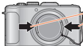
Zum Anbringen und Abnehmen des Objektivdeckels drücken Sie auf die in der Abbildung durch Pfeile gekennzeichneten Stellen.
