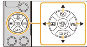
Auch wenn die Kamera mit dem Touchscreen bedient wird, ist es möglich, mit der Cursor-Taste und der [MENU/SET]-Taste zu arbeiten, wenn eine Anleitung, wie der rechts gezeigten, zu sehen ist.
