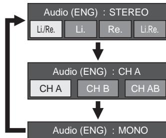
Sie können mit  $\blacktriangleleft/\blacktriangleright$  den linken (Li.) oder rechten (Re.) Kanal wählen, wenn der Menübalken STEREO oder DUAL MONO eingeblendet ist.
