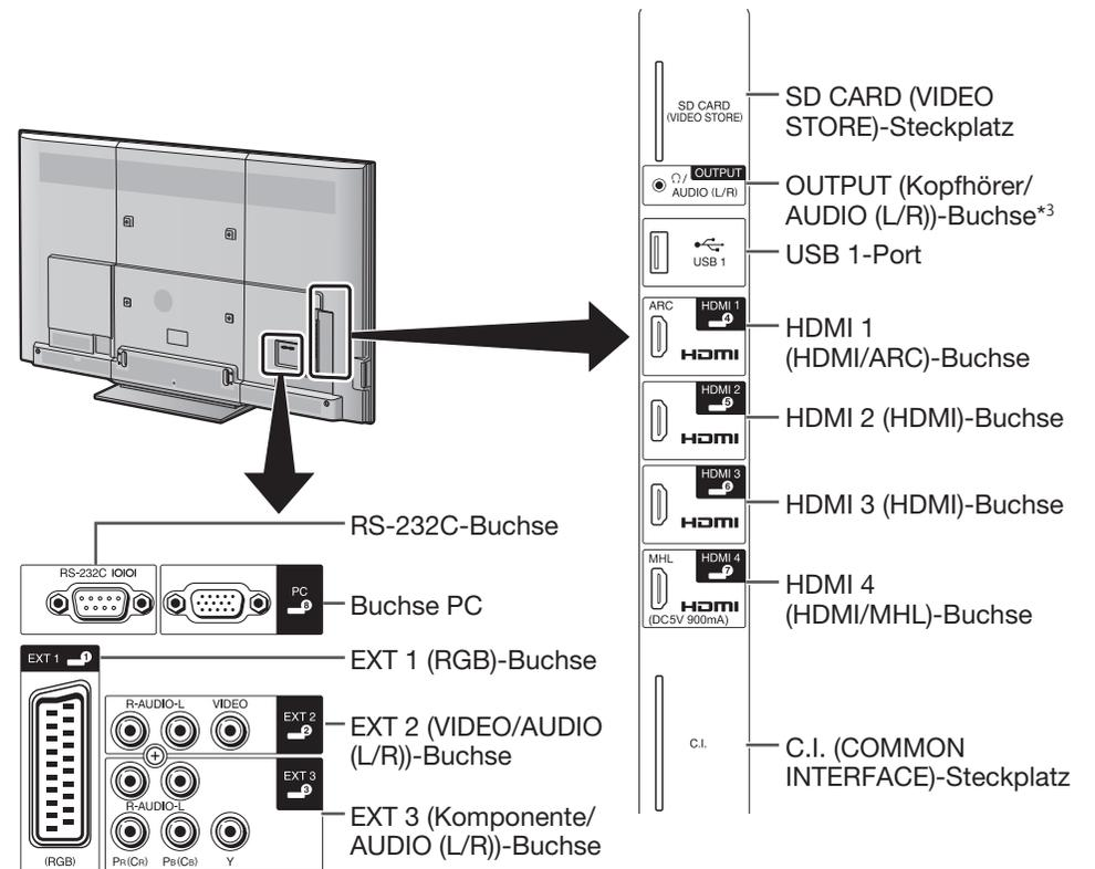
\*3 Wenn der Kopfhörer an die OUTPUT-Buchse angeschlossen wird, kann der Ton über die Lautsprecher wiedergegeben werden (Seite 48).
