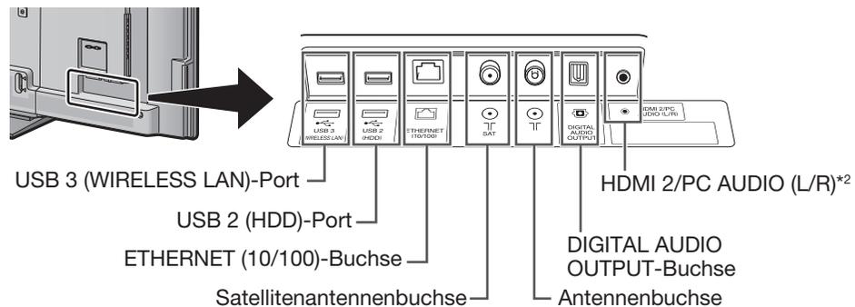
\*2 Für die Buchsen HDMI 2 und PC kann dieselbe Toneingangsbuchse verwendet werden (HDMI 2/PC AUDIO (L/R)). Hierfür muss aber im Menü „Audiowahl“ der richtige Punkt gewählt werden (Näheres siehe Seite 47).
