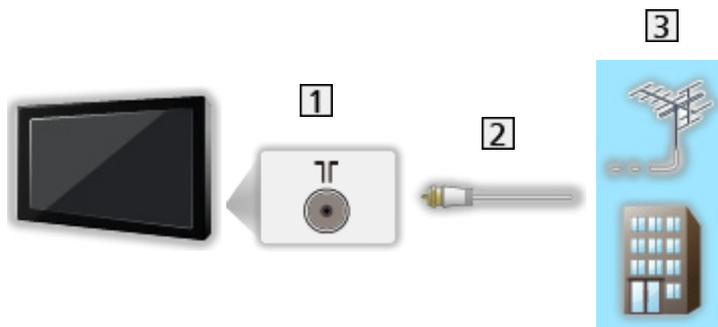
1 Anschluss für terrestrische Antenne / Kabel
