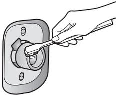
7. Wenn das Gerät mit einem Schlauch mit Wasserzuleitungsventil geliefert wird, drehen Sie den Wasserhahn zu, trennen Sie den Schlauch vom Hahn und reinigen Sie den Schlauchfilter auf dieselbe Weise.
