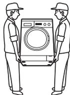
Beginnen Sie, indem Sie die Maschine nach hinten kippen. Die Maschine sollte von zwei Personen getragen werden, wobei sie jeweils eine auf jeder Seite am Boden hält.
