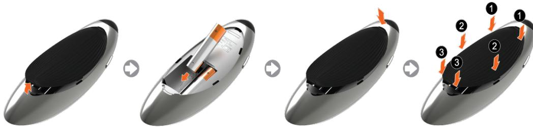
1. Ziehen Sie vorsichtig an der Kerbe der Batterieabdeckung, und entfernen Sie die Abdeckung, nachdem Sie sich gelöst hat.
