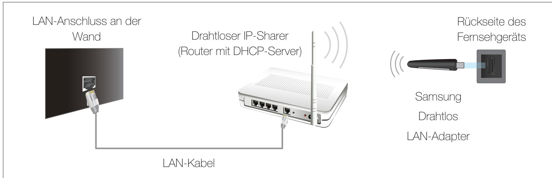
Der Samsung WLAN-Adapter wird bei ausgewählten Einzelhändlern, E-Commerce-Sites. Der Samsung WLAN-Adapter unterstützt die Kommunikationsprotokolle IEEE 802,11 a/b/g und n. Samsung empfiehlt, IEEE 802,11 n zu verwenden. Wenn Sie Video über die netzwerk -Verbindung anzeigen, wird das Videobild möglicherweise nicht ohne Unterbrechungen angezeigt.
