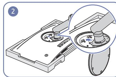
Bringen Sie den Standfuß an der Rückseite des Monitors in Pfeilrichtung an.
