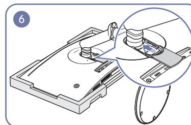
Richten Sie die RÜCKABDECKUNG UNTEN auf der Rückseite des Monitors aus und drücken Sie sie in Pfeilrichtung in die Rille.
