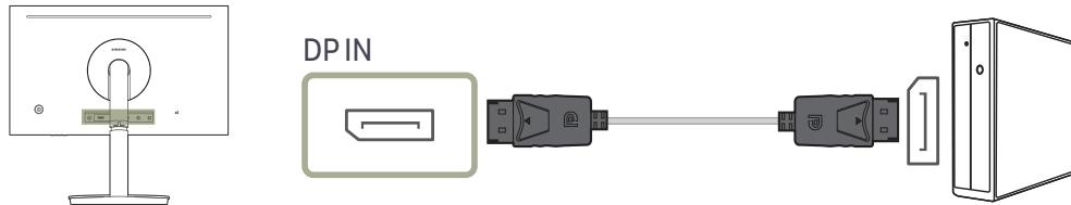
Verwenden Sie möglichst ein DP-Kabel mit einer Länge von maximal 1,5 m. Wenn das Kabel länger als 1,5 m ist, kann die Bildqualität beeinträchtigt sein.
