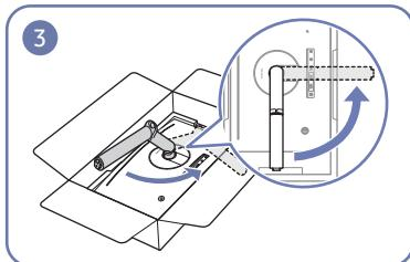
Drehen Sie das Halsstück des Standfußes 90° im Gegenurzeigersinn und bewegen Sie den Verbindungsbereich über den Rand der Verpackung.
