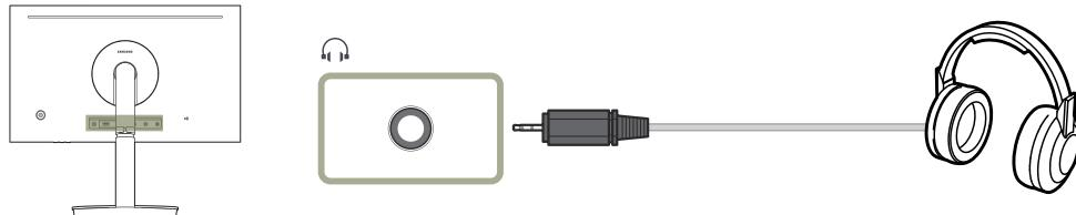
Verwenden Sie Kopfhörer, wenn Sie den Ton mit einem HDMI-HDMI- oder DP-Kabel aktivieren.
