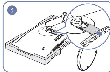
Entfernen Sie die RÜCKABDECKUNG UNTEN in Pfeilrichtung.
