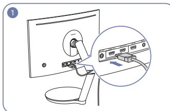
Schließen Sie die Kabel an die richtigen Anschlüsse an.
