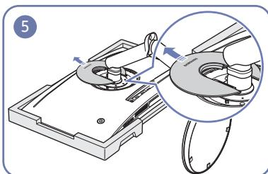
Entfernen Sie die RÜCKABDECKUNG OBEN in Pfeilrichtung.
