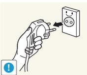
Fassen Sie das Netzkabel am Stecker und nicht am Kabel an, wenn Sie es aus der Wandsteckdose ziehen.
