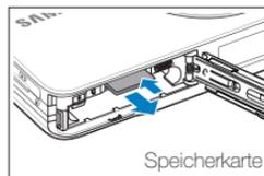
Drücken Sie vorsichtig gegen die Speicherkarte, so dass sie ausrastet, und ziehen Sie sie dann aus dem Speicherkarteneinschub.
