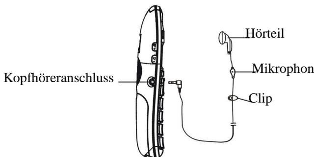
Der Anschluss für den Kopfhörer befindet sich an der linken Seite des Mobilteils und hat einen Standardanschluss von 2,5mm. Den Kopfhörer einfach in diesen Anschluss stecken, so dass er aktiviert werden kann.
