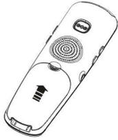
3. Zum Schließen Batterieabdeckung bitte soweit nach oben schieben, bis sie einklickt.
